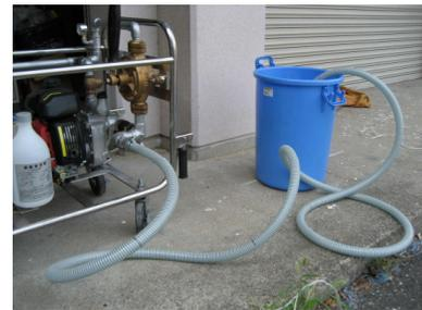
②薬液ボトルの線が書いてある所までピューラックス(滅菌剤)を入れ、ろ過器を通した水で薄めます。(希釈倍率20倍)セットしたら、青いホースをさし込みます。
