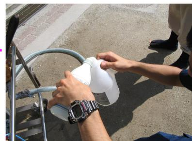
③浄水運転をしながら(手動でポンプを動かしながら)ピューラックスの目盛を2~3にして濃度を調整します。
